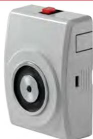
Retenedor de pared de 400N con caja y pulsador, para puerta cortafuego . Caja de plástico reforzado con fibra y pulsador de desbloqueo rojo. El equipo libera la puerta cuando se deja de aplicar la tensión de 24 Vcc. Incluye diodo de protección y polarización y placa ferromagnética articulada Ref. 960110.
